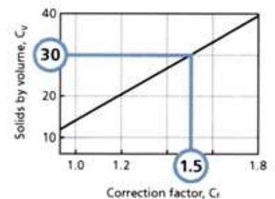
**4. Agora foi determinado** o ponto de serviço necessário ( $H_{total}$ ). Se a concentração de sólidos superar 15% do volume, deve reduzir a altura de descarga da bomba. Dividindo a altura de serviço pelo fator de redução (HR), obtém-se a altura de elevação da bomba equivalente à água limpa.
